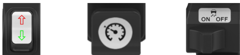
Figur 26. Omkopplare och indikatorer (från vänster till höger) för riktning; Walk; Cruise; Traction.
